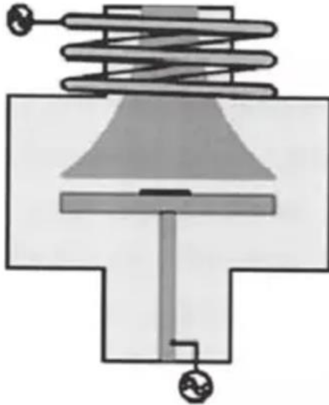
图 ICP-PECVD 沉积反应腔室示意图
