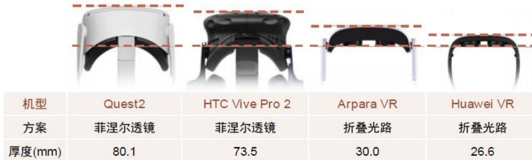
图表13：搭配菲涅尔透镜方案和Pancake方案的头显厚度对比
