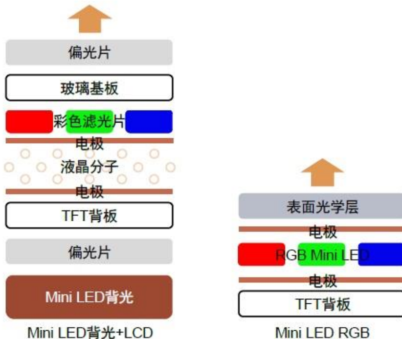
图表25: Mini LED背光及直显结构图
