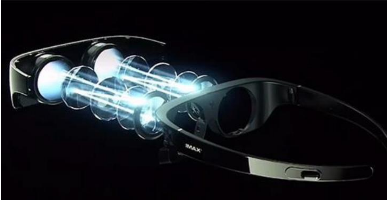
图表15：三片式折叠光路
