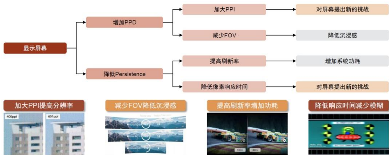
图表19: VR显示屏幕的核心参数
