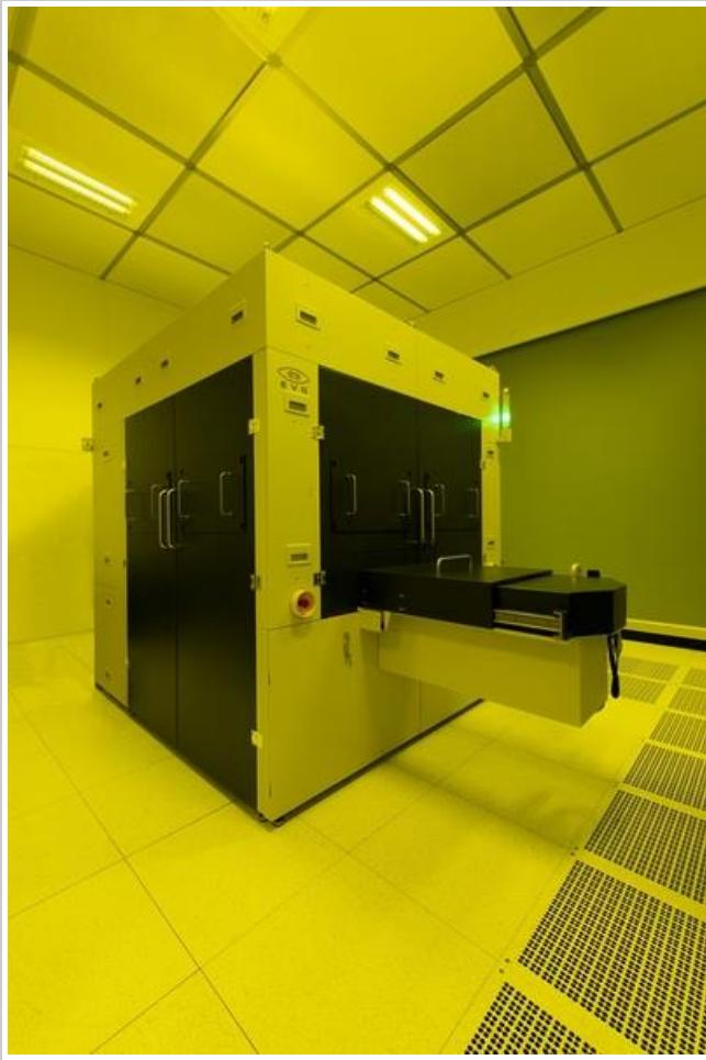
台北, 2021年6月9日 — 微機電系統 (MEMS)、奈米科技與半導體市場的晶圓接合暨微影技術設備之領導廠商EV Group (EVG)，今天宣布推出次世代的步進重複奈米壓印微影 (NIL) 系統EVG®770 NT。EVG770 NT可以為擴增實境 (AR) 波導管、晶圓級光學技術 (WLO) 及先進實驗室晶片元件量產使用的大面積母模加工，促成微型與奈米圖案的精準複製。在此之前，步進重複NIL的進一步開發與生產微縮化的需求，往往受限於較大面積上精準母模的可用性。借助EVG在NIL與步進重複母模累積數十年的經驗，EVG770 NT的設計旨在成為一套讓效能、生產力與製程控制性極大化的完全生產導向系統，並提供領先業界的疊層精準度與解析度，尺寸最高可以放大至300mm晶圓及第二代面板尺寸。因此，今後客戶可以實現量產、具成本效益與高保真度的NIL圖案成形。
