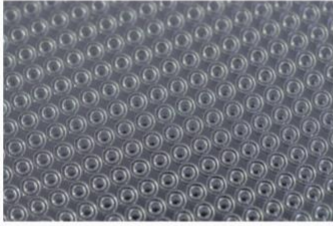
用于晶圆级光学器件的300毫米分步重复母版
