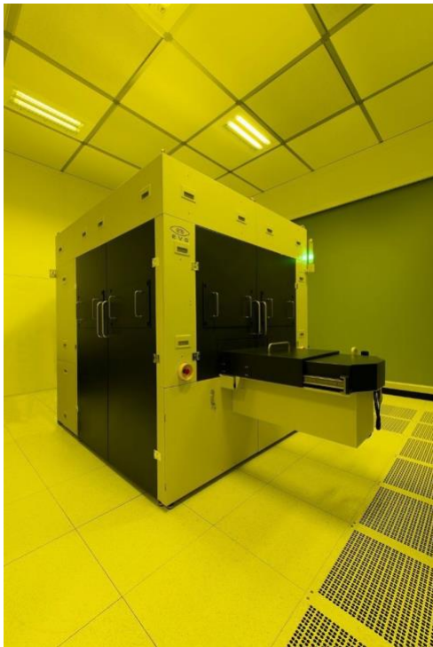
EVG 770 NT步進重複奈米壓印微影系統。
