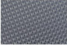
用于晶圆级光学器件的300毫米分步重复母模
