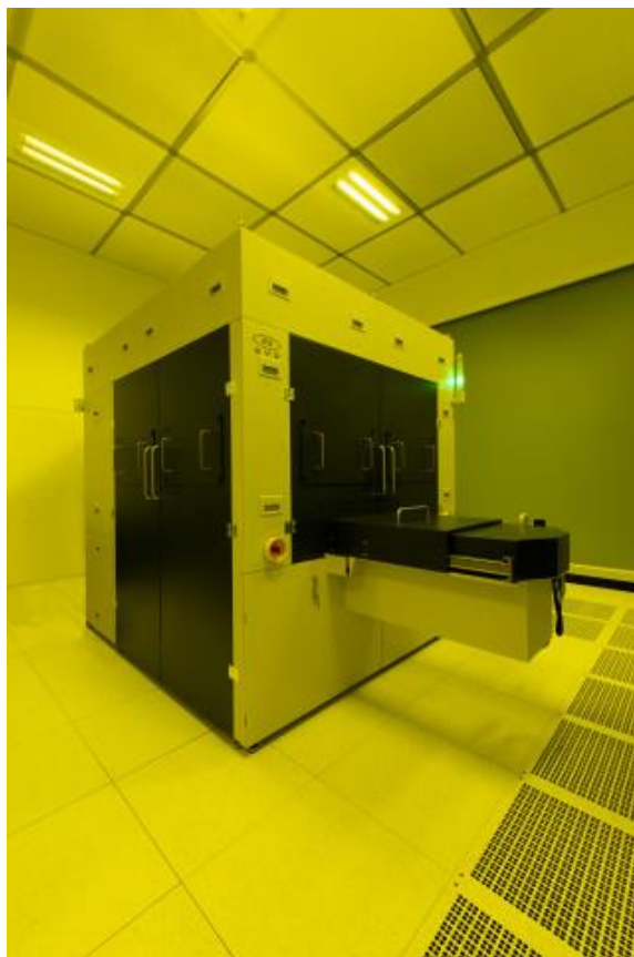
EV 그룹이 출시한 EVG®770 NT 스텝-앤드-리피트 나노임프린트 리소그래피 시스템
