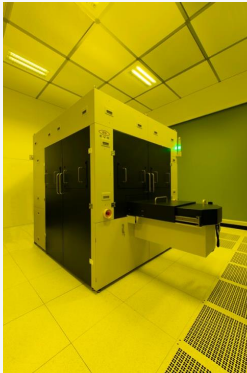
▲ 스텝-앤드-리피트(step-and-repeat) 나노임프린트 리소그래피(NIL) 시스템 'EVG 770 NT'
