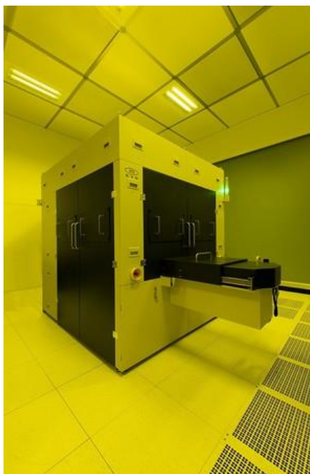
EVG 770 NT步進重複奈米壓印微影系統為擴增實境波導管、晶圓級光學技術與先進生物醫學晶片，促成微型與奈米結構的大面積母模加工。
