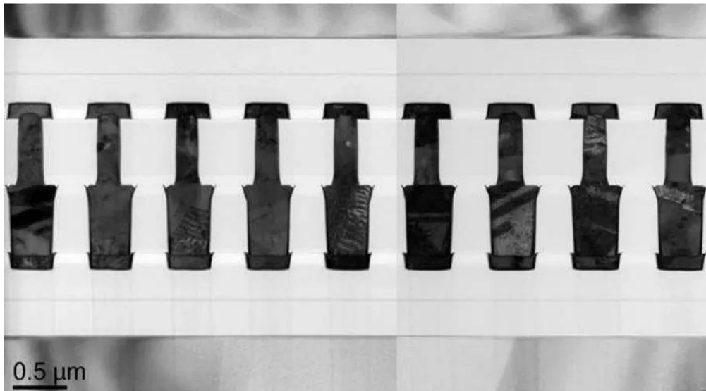
图：晶圆与晶圆混合键合，具有700nm金属间距（来源：伊梅克，IEDM）
