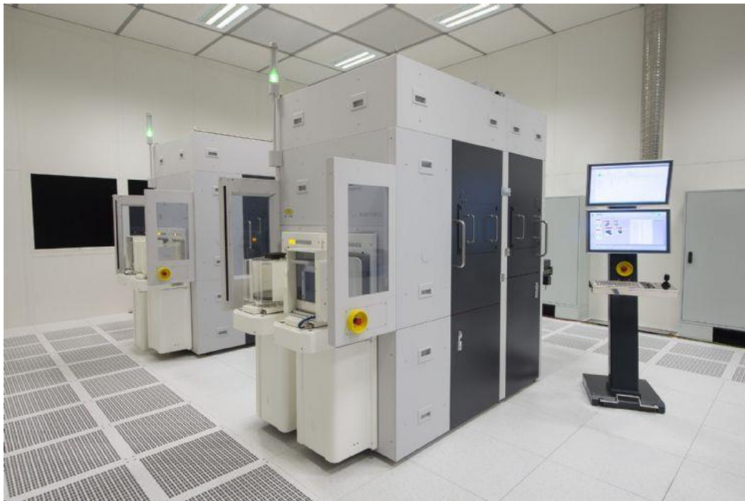
EVG 7300 SmartNIL奈米壓印與晶圓級光學系統是具備多功能且先進的解決方案，可在單一平台上結合多重基於UV架構的製程。益高科技
