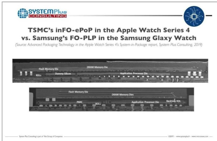
最常见的先进封装类别称为扇出。有些人会争辩说它甚至不是先进的封装，但那些人大错特错。以Apple 为例，他们将让台积电采用应用处理器芯片，并将其与 90 微米到 60 微米数量级的更密集凸块封装到重组或载体晶圆/面板上。与传统倒装芯片封装相比，凸点密度大约高出 8 倍。这种重组或载体晶圆/面板然后进一步展开 IO，因此得名扇出。然后将扇出封装连接到主板。硅芯片的设计可以减少对pad受限的担忧，因为扇出处的pad较小。该封装还可以封装 DRAM 内存、NAND 存储和 PMIC。集成扇出不仅有利于密度，而且它们还在封装上保留了大量的芯片间 IO。否则，该 IO 将不得不以更大的IO 间距尺寸通过主板进行接口。集成扇出对于高性能应用程序变得越来越普遍，不仅仅是移动应用程序。增长最快的用例是在十多年来设计一直受到限制的事物的网络方面。AMD 将在其服务器 CPU 和 GPU 中非常积极地采用扇出。Tesla Dojo 1是集成扇出封装的另一个引人注目的例子，但在晶圆级。SemiAnalysis透露，特斯拉将在发布公告前使用这种包装类型。
