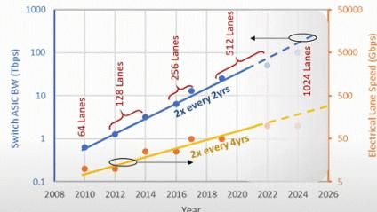
芯片上数据的输入和输出 (IO) 是计算的命脉。将内存置于芯片上有助于通过减少通信开销来减少 IO 需求，但归根结底，这是一种有限的扩展途径。处理器必须与外部世界进行交易以发送和接收数据。摩尔定律使业界的晶体管密度大约每 2 年增加 2 倍，但 IO 数据的速率每 4 年才增加 2 倍。几十年来，晶体管密度与 IO 数据速率的这种差异出现了巨大差异。共同封装的光学器件只是解决这个问题的一种方法，它并不是单独出现的。从根本上说，芯片需要容纳更多的通信或 IO 点才能跟上。不幸的是，这方面的最后一个主要步骤功能增加是在 90 年代转向倒装芯片封装。
