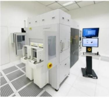
EV集团LITHOSCALE®无掩模曝光光刻系统，为ITRI的异构集成芯片组件系统封装联盟（Hi-CHIP）提供革新的工艺解决方案
