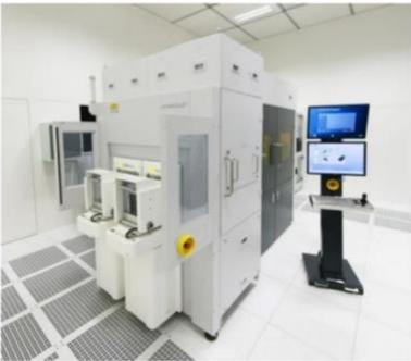
EV集团LITHOSCALE无掩模曝光光刻系统, 为ITRI的异构集成芯片组件系统封装联盟 (HI-CHIP) 提供革新化的工艺解决方案
