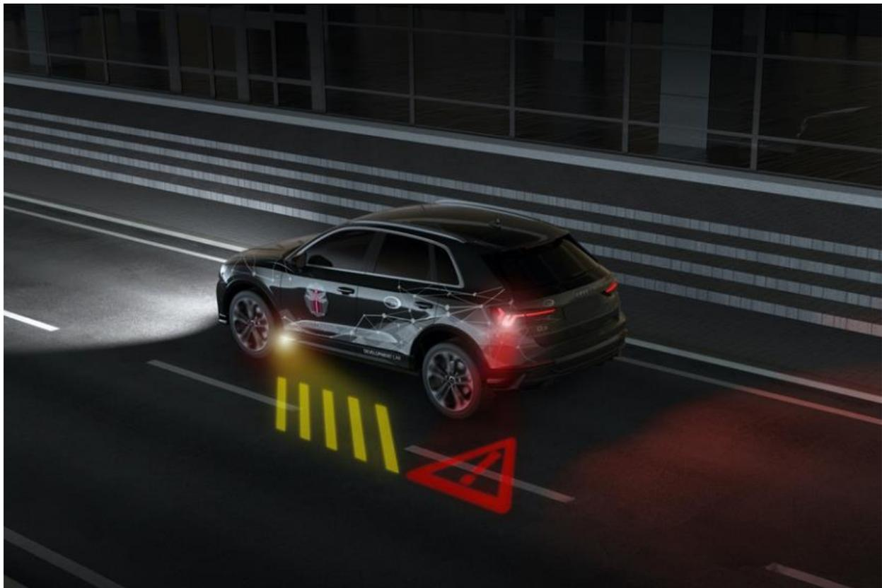
**ZKW entwickelt mit Partnern neue Mikrospiegel-Module für dynamische Lichtfunktionen.**
