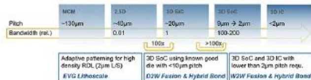
圖3 未來的頻寬需求帶動更緊密晶片堆疊技術
