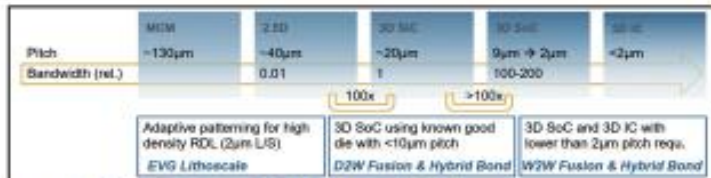
圖3 未來的頻寬需求帶動異質整合與晶片堆疊技術
