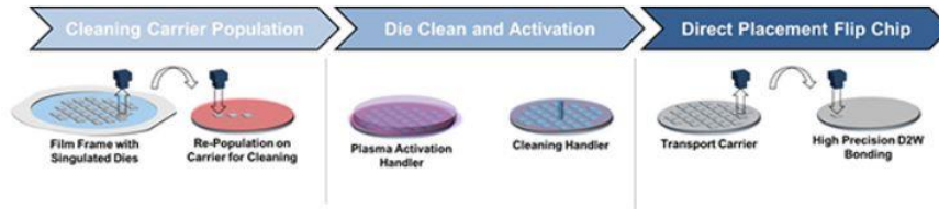
圖4 直接配置晶粒到晶圓接合方法
